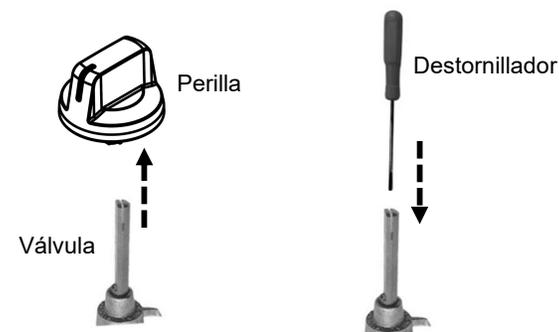
**Nota:** Girar a la derecha para cerrar la presión y quede calibrado para Gas Licuado de Petróleo (GLP) y/o girar a la izquierda para abrir la presión y quede calibrado para Gas Natural (GN).
