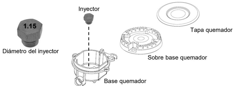
3. Retira la tapa quemador y la sobre base quemador de la base quemador.
